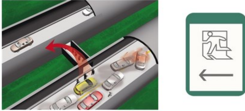
图 2.7 相邻隧道方案的逃生救援通道[11]
