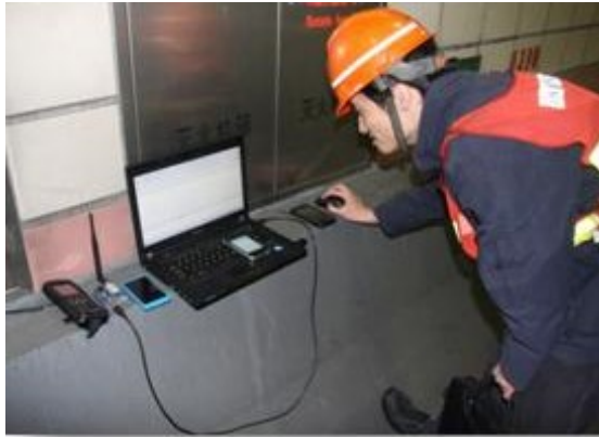
图 12 现场测试 Zigbee 无线信号对设备的干扰
